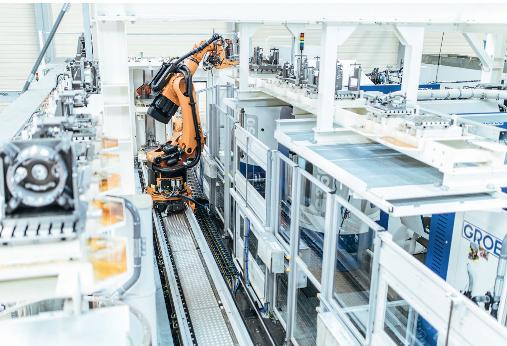
1 Drei Werkzeugmaschinen des Herstellers Grob bearbeiten Roboter-Werkstücke. Ein KR-Fortec-Roboter fährt diese über eine Lineareinheit zum Be- und Entladen an (© Kuka)
